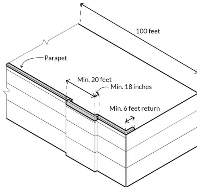
FIGURE 18.11.040.E.2.B: ROOFLINE OFFSET, PARAPETS AND PARAPET SUBSTITUTION
